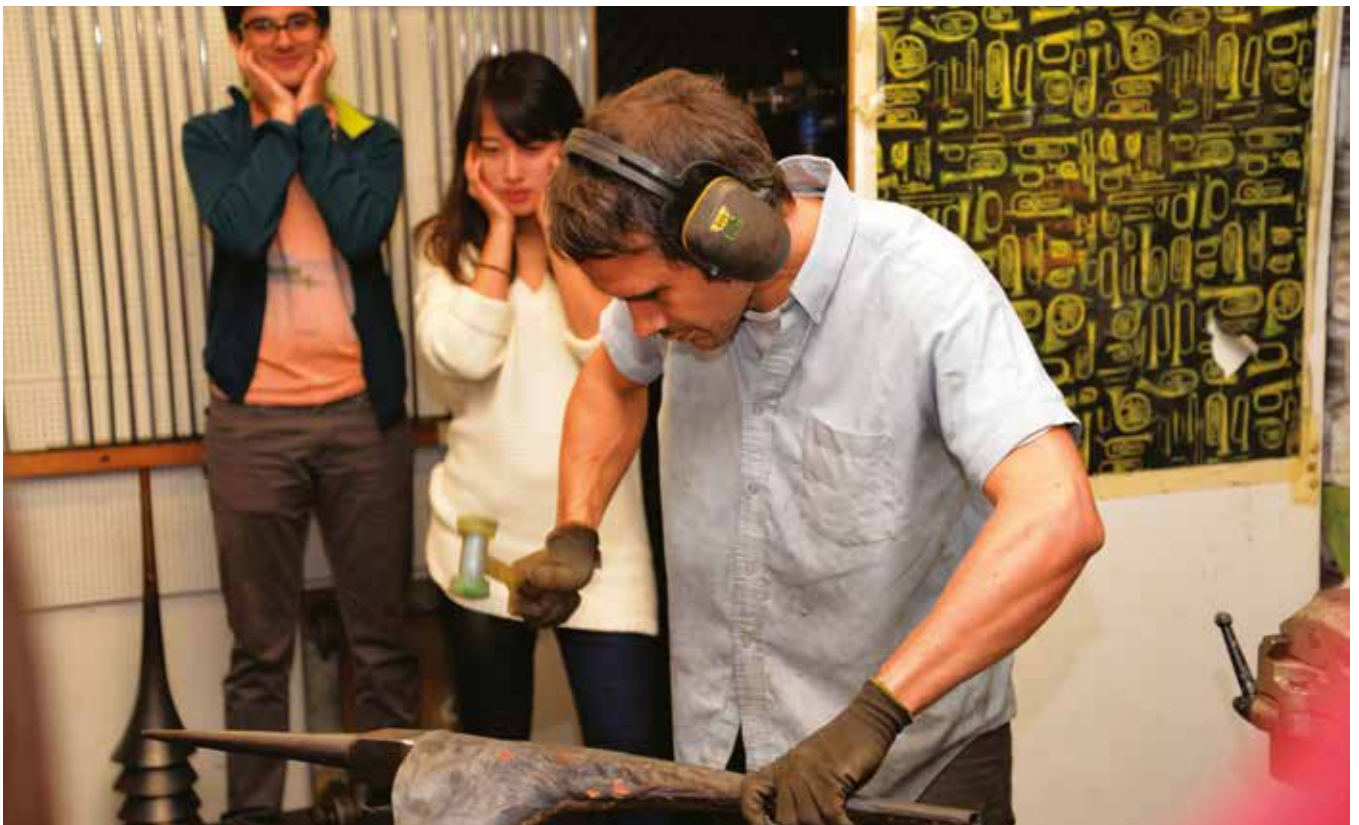
Alex Schölkopf bearbeitet den Rohling einer Barockposaune.
